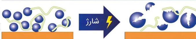
استفاده از گرافن در کنار سیلیکون در باتری
