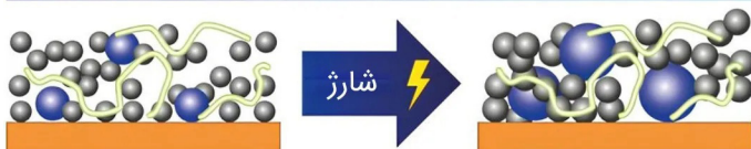
استفاده از گرافن در کنار سیلیکون در باتری
